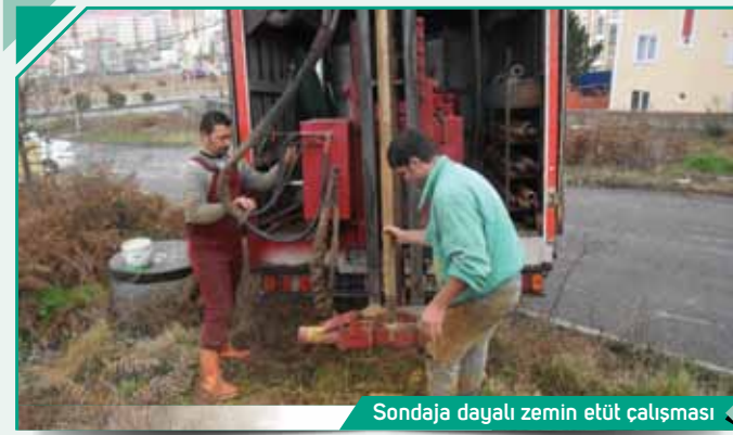
Sondaja dayalı zemin etüt çalışması
